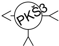
PROPLACHOVACÍ A KONTROLNÍ ŠACHTA S LAPAČEM PÍSKU
